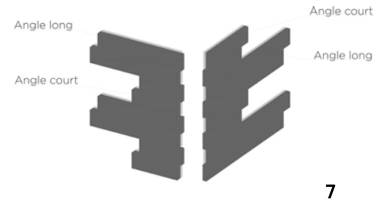
Pour les murs avec des angles : pour éviter que les joints soient regardés, utiliser une combinaison d'angle longue et courte, en alternant entre les lignes. Par exemple, première ligne une pièce longue-courte, seconde ligne une pièce courte-longue, etc.
